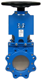
Serie 702/10 Plaatafsluiter met niet-stijgende spindel en handwiel RVS plaat Nodulair gietijzer DN 50-1200 Drukklassse PN 10
