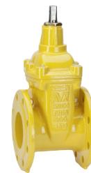
Serie 06/70 Flensafsluiter Vervangbare spindelafdichting Korte inbouw lengte, F4 Nodulair gietijzer DN 40-300 Drukklassse PN 16
