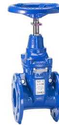
Serie 06/35 Flensafsluiter met standindicatie en handwiel Korte inbouw lengte, F4 RVS 304 spindel NBR schuif Nodulair gietijzer DN 50-400 Drukklassse PN 10/16
