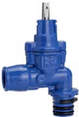
AVK Serie 103/31-003 Supa Lock™ Haakse dienstkraan voor zij-aanboring met spie- eind /push-in mof-eind Nodulair gietijzer drukklasse PN 16
