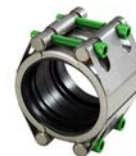
AVK serie 745/28, Repico® type SD Flexibele koppeling tweedelig RVS 316 Rubber: NBR, EPDM, Silicone of FKM DN 650-1000 Max. werkdruk: 7,2 - 10,7 bar
