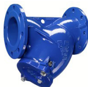
AVK serie 910 Y-strainer Nodulair gietijzer / RVS A2 aftapplug DN 50-300 drukklasse PN 16
