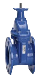
AVK serie 15/42 Afsluiter met topflens geschikt voor elektrische aandrijving Korte inbouw lengte, F4 Nodulair gietijzer DN 40-400 Drukklasse PN 10/16
