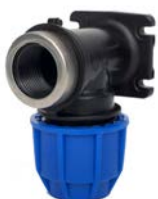
AVK serie 1110/16 Bocht voor wandmontage PE x inwendig draad Polypropyleen huis, moer en aandrukkring Polyacetaal klemring EPDM afdichting Schroefverbinding
