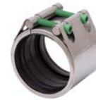
AVK serie 745/20, Repico® type S Flexibele koppeling RVS 316 Rubber: NBR, EPDM, Silicone of FKM DN 20-600 Max. werkdruk: 11,2 - 42,7 bar
