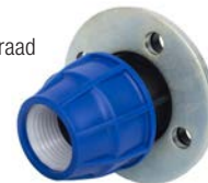
AVK serie 1110/15 Flenshulpstuk, PE x flens Polypropyleen huis, moer en aandrukkring Polyacetaal klemring EPDM afdichting Schroefverbinding
