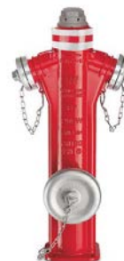
AVK serie 84/16 Bovengrondse brandkraan type P7 met dubbele afdichting dmv. kogel, breekhoutbeveiliging, 2x storkoppeling, 1x motorspuitaansluiting Nodulair gietijzer DN 100 drukklasse PN 16
