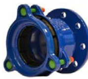
AVK serie 711/60 Orion flensadapter Nodulair gietijzer NBR of EPDM rubber DN 50-300 drukklasse PN 16
