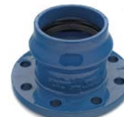
AVK serie 712 E Flensmof stuk Nodulair gietijzer Epoxy gecoat DN 50-600 drukklasse PN 16
