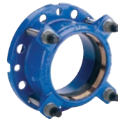
AVK serie 623/10 Supa Plus™ flensadapter met pakking voorzien van trekvaste ring voor PE en PVC buizen Nodulair gietijzer DN 40-300 drukklasse PN 16
