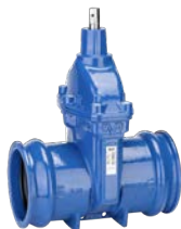
AVK serie 01/80 Mofafsluiter voor kunststof buizen Nodulair gietijzer DN 40-400 Drukklasse PN 16
