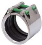
AVK serie 745/01, Repico® type G Trekvaste koppeling RVS 316 Rubber: NBR, EPDM, Silicone of FKM DN 15-400 Max. werkdruk: 16,0 - 42,7 bar
