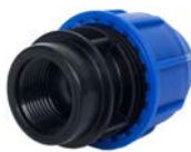
AVK serie 1110/05 Adapter PE x inwendig draad Polypropyleen huis, moer en aandrukkring Polyacetaal klemring EPDM afdichting Schroefverbinding KIWA Water Mark
