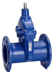
AVK serie 02/63 Flensafsluiter Lange inbouw lengte, F5 Nodulair gietijzer Spindel RVS 316 DN 50-400 Drukklasse PN 16
