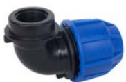
AVK serie 1110/13 90° Bocht PE x inwendig draad Polypropyleen huis, moer en aandrukkring Polyacetaal klemring EPDM afdichting Schroefverbinding
