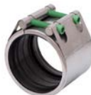
AVK serie 745/24, Repico® type SF Flexibele koppeling voor hoge drukken RVS 316 Rubber: NBR, EPDM, Silicone of FKM DN 65-600 Max. werkdruk: 16,0 - 42,7 bar
