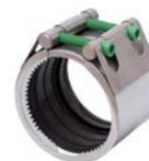
AVK serie 745/52, Repico® type SG Slip-Grip koppeling Trekvaste zijde en niet- trekvaste zijde RVS 316 Rubber: NBR, EPDM, Silicone of FKM DN 15-300 Max. werkdruk: 18,7 - 42,7 bar
