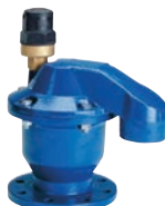
AVK serie 701/50 Be- / ontlufter voorzien van flens inlaat Grijs gietijzer / versterkt polyamide DN 50-300 drukklasse PN 16
