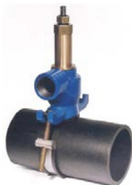
AVK serie 727/08 Aanboorzadel type SWIC ST met geïntegreerde frees voor gietijzeren, asbest cement en stalen buizen Nodulair gietijzer DN 80-300 drukklasse PN 16
