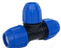
AVK serie 1110/10 90° Verloop T-stuk, PE x PE x PE Polypropyleen huis, moer en aandrukkring Polyacetaal klemring EPDM afdichting Schroefverbinding KIWA Water Mark
