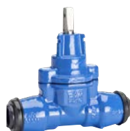
AVK serie 03/30 Dienstleidingafsluiter met trekvaste mofverbindingen voor PE-buizen Nodulair gietijzer DN 25-50 drukklasse PN 16
