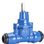
AVK serie 03/00 Dienstleidingafsluiter voorzien van inwendige draad Nodulair gietijzer DN 25-50 drukklasse PN 16
