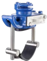
AVK serie 100/75 Supa Lock™ Aanboorzadel voorzien van afsluitcassette voor gietijzeren / stalen buizen Ø 50-360 mm Nodulair gietijzer drukklasse PN 16
