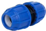
AVK serie 1110/01 Koppeling PE x PE Polypropyleen huis, moer en aandrukkring Polyacetaal klemring EPDM afdichting Schroefverbinding KIWA Water Mark
