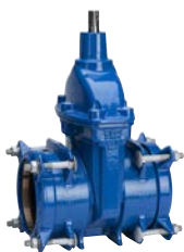
AVK serie 01/70 Mofafsluiter met Supa Plus™ aansluiting Nodulair gietijzer Trekvast voor PE en PVC buizen DN 40-300 Drukklasse PN 16
