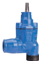
AVK serie 11/30 Haakse dienstleidingafsluiter met uitwendig draad op inlaat en trekvaste mofverbinding for PE-buizen op uitlaat Nodulair gietijzer DN 25-50 drukklasse PN 16
