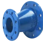
AVK serie 712 FFRe Excentrisch flensverloopstuk Nodulair gietijzer Epoxy gecoat DN 50-600 drukklasse PN 16
