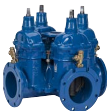
AVK serie 18 Combi-cross met 4 uitgangen Nodulair gietijzer DN 100-400 drukklasse PN 10/16
