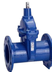
AVK serie 02/60 Flensafsluiter Lange inbouw lengte, F5 Nodulair gietijzer DN 40-400 Drukklasse PN 16
