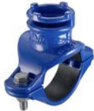
AVK Serie 100/14 Supa Lock™ Aanboorzadel voor gietijzeren / stalen buizen Ø 60-223 mm Nodulair gietijzer drukklasse PN 16
