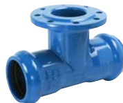
AVK serie 712 MMA Flensmof T-stuk Nodulair gietijzer Epoxy gecoat DN 80-600 drukklasse PN 16
