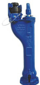
AVK serie 35/57 Ondergrondse brandkraan met insluibeveiliging Nodulair gietijzer DN 80 drukklasse PN 16
