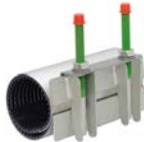
AVK serie 748/01 Reparatieklem, type FS10 met ge vulkaniseerde spannerplate RVS 304 of 316 NBR of EPDM rubber Diameterbereik: 48 mm - 360 mm
