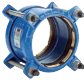
AVK serie 621/10 Supa Plus™ koppeling met trekvaste ring voor PE en PVC buizen Nodulair gietijzer DN 32-300 drukklasse PN 16
