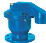
AVK serie 701/30 Lucht & Vacuüm afsluiter voorzien van flens inlaat Nodulair gietijzer DN 50-300 drukklasse PN 16
