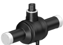
AVK serie 85/50 Kunststof kogelkraan tbv. water met PE lasuiteinden PE100, SDR 11 25 mm t/m 180 mm drukklasse PN 10
