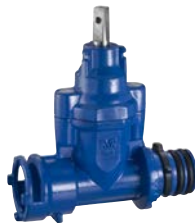
AVK serie 103/00 Supa Lock™ Dienstleidingafsluiter met spie/mof verbinding Nodulair gietijzer drukklasse PN 16
