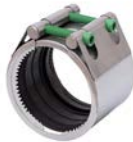
AVK serie 745/05, Repico® type GF Trekvaste koppeling voor hoge drukken RVS 316 Rubber: NBR, EPDM, Silicone of FKM DN 65-300 Max. werkdruk: 26,7 - 42,7 bar
