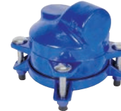
AVK serie 624/10 Supa Plus™ eindkap met trekvaste ring voor PE en PVC buizen Nodulair gietijzer DN 40-300 drukklasse PN 16
