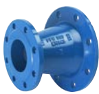
AVK serie 712 FFR Verloopstuk voor flensverbindingen Nodulair gietijzer Epoxy gecoat DN 50-1200 drukklasse PN 16
