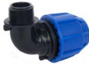
AVK serie 1110/14 90° Bocht PE x uitwendig draad Polypropyleen huis, moer en aandrukkring Polyacetaal klemring EPDM afdichting Schroefverbinding
