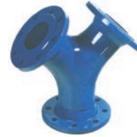
AVK serie 712 Y Y-stuk Nodulair gietijzer Epoxy gecoat DN 80-600 drukklasse PN 16
