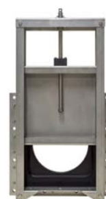
AVK serie 772/RVS schuif Rioolspindelschuif Gesloten frame tbv. wandmontage Frame RVS 316 Schuif RVS 316 EPDM afdichting DN 200-1000
