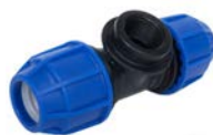
AVK serie 1110/08 90° T-stuk PE x inwendig draad x PE Polypropyleen huis, moer en aandrukkring Polyacetaal klemring EPDM afdichting Schroefverbinding KIWA Water Mark
