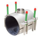
AVK serie 748/22 Reparatieklem, type FSA20 met ge vulkaniseerde spannerplate Draadaftakking 1/2"-2" RVS 304 of 316 NBR of EPDM rubber Diameterbereik: 88 mm - 650 mm
