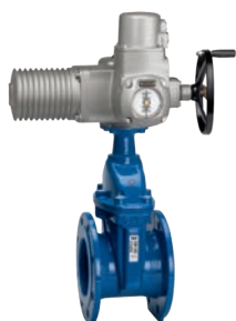
AVK serie 15/43 Afsluiter met topflens geschikt voor elektrische aandrijving, korte inbouw lengte, F4, RVS 316 spindel Nodulair gietijzer DN 40 - 400 drukklasse PN 16
