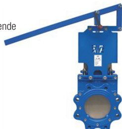
AVK serie 702/30 Plaatafsluiter met hefboom Nodulair gietijzer RVS plaat DN 50-150 drukklasse PN 10
