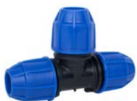
AVK serie 1110/07 90° T-stuk, PE x PE x PE Polypropyleen huis, moer en aandrukkring Polyacetaal klemring EPDM afdichting Schroefverbinding KIWA Water Mark
