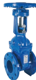
AVK serie 06/89 Flensafsluiter voorzien van stijgende spindel en handwiel Nodulair gietijzer / NBR schuif DN 50-400 drukklasse PN 10/16
