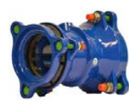
AVK serie 711/70 Orion verloopkoppeling Nodulair gietijzer NBR of EPDM rubber DN 80-250 drukklasse PN 16
