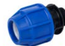
AVK serie 1110/06 Adapter PE x uitwendig draad Polypropyleen huis, moer en aandrukkring Polyacetaal klemring EPDM afdichting Schroefverbinding KIWA Water Mark
