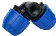
AVK serie 1110/17 90° Bocht PE x PE x uitwendig draad op 90° Polypropyleen huis, moer en aandrukkring Polyacetaal klemring EPDM afdichting Schroefverbinding
