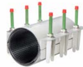
AVK serie 748/02 Reparatieklem, type FS20 met ge vulkaniseerde spannerplate Voorzien van scharnierpunt RVS 304 of 316 NBR of EPDM rubber Diameterbereik: 88 mm - 650 mm
