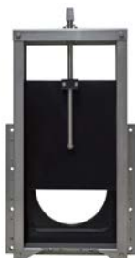
AVK serie 772/HDPE schuif Rioolspindelschuif Gesloten frame tbv. wandmontage Frame RVS 316 Schuif HDPE EPDM afdichting DN 200-1000
