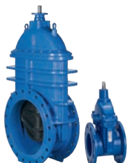
AVK serie 06/80 Flensafsluiter korte bouw lengte, F4, RVS 304 spindel Nodulair gietijzer / NBR schuif DN 40-1000 drukklasse PN 10/16
