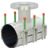
AVK serie 748/32 Reparatieklem, type FST20 met ge vulkaniseerde spannerplate Flensaftakking 3" - 8" RVS 304 of 316 NBR of EPDM rubber Diameterbereik: 270 mm - 840 mm
