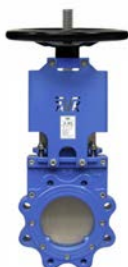
AVK serie 702/20 Plaatafsluiter met stijgende spindel en handwiel Nodulair gietijzer / RVS plaat DN 50-1200 drukklasse PN 10
