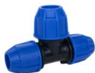
AVK serie 1110/11 90° Verloop T-stuk, PE x PE x PE Polypropyleen huis, moer en aandrukkring Polyacetaal klemring EPDM afdichting Schroefverbinding KIWA Water Mark
