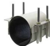
AVK serie 748/02 Reparatieklem, type FS20 met ge vulkaniseerde spannerplate Voorzien van scharnierpunt EPDM of NBR rubber RVS 304L of 316L DN 80-600
