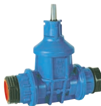
AVK serie 16/90 Dienstleidingafsluiter met PRK koppelingen voor PE buizen POM (Polyoxymethyleen) DN 25-50 Drukklasse PN 16
