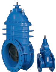
AVK serie 06/80 Flensafsluiter Korte inbouw lengte, F4 RVS 304 spindel NBR schuif Nodulair gietijzer DN 40-1200 Drukklasse PN 10/16
