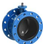
AVK serie 75/21 Centrische vlinderklep met ge vulkaniseerde voering Dubbel geflensd (lang), type EVFL Inbouw lengte DIN 3202-F4 Nodulair gietijzer DN 50-1000 Drukklasse PN 10/16
