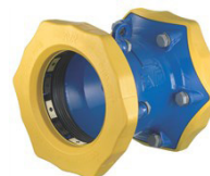
Serie 635/00 Supa Maxi™ universele trekvaste overgangs- koppeling met gemonteerde PE100 buis Nodulair gietijzer EPDM rubber DN 50-300 Drukklasse PN 10 (SDR17) of PN 16 (SDR11)
