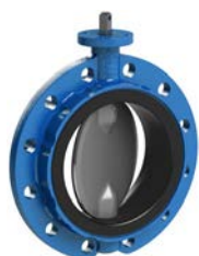
AVK serie 75/51 Centrische vlinderklep met ge vulkaniseerde voering Monoflens, type EVML Inbouw lengte DIN 3202-K3 Nodulair gietijzer DN 80-800 Drukklasse PN 10/16
