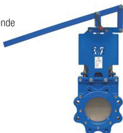
AVK serie 702/30 Plaatafsluiter met hefboom RVS plaat Nodulair gietijzer DN 50-150 Drukklasse PN 10
