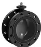
AVK serie 75/20 Centrische vlinderklep met ge vulkaniseerde voering Dubbel geflensd (kort), type EVFS Inbouwlengte DIN 3202-F16 Nodulair gietijzer DN 50-2000 Drukklassse PN 10/16
