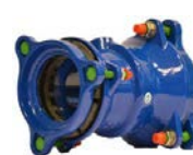
AVK serie 711/70 Orion universele verloop koppeling Niet trekvast Nodulair gietijzer EPDM rubber DN 80-250 Drukklasse PN 16
