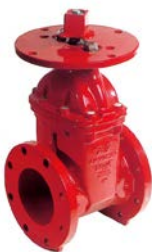
AVK serie 45/5D Flensafsluiter met montageplaat voor post indicator ANSI 125/150 Nodulair gietijzer DN 50-300: 17.2 bar/250 PSI DN 350-400: 13.7 bar/200 PSI UL/ULC listed FM approved
