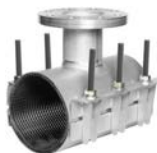
AVK serie 748/32 Reparatieklem, type FST20 met ge vulkaniseerde spannerplate Flensaftakking 3"-8" EPDM of NBR rubber RVS 304L of 316L DN 40-350
