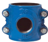
AVK serie 10/00 Aanboorzadel voor PE/PVC buizen Nodulair gietijzer DN 40-300 Vanaf DN 250 met RVS onderbeugel Drukklasse PN 16
