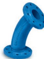
AVK serie 712 FFK 45° Flensbocht 45° Nodulair gietijzer Epoxy gecoat DN 50-1200 Drukklasse PN 16
