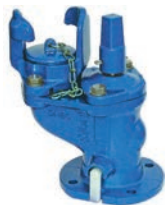
AVK serie 35/00 Ondergrondse brandkraan zonder insluitbeveiliging Enkelvoudige afdichting Nodulair gietijzer DN 80 600 mm Drukklasse PN 16
