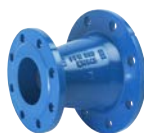
AVK serie 712 FFR Verloopstuk voor flensverbindingen Nodulair gietijzer Epoxy gecoat DN 50-1200 Drukklasse PN 16
