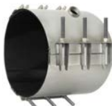
AVK serie 748/23 Reparatieklem, type FSA30 met ge vulkaniseerde spannerplate Draadaftakking ½"-2" EPDM of NBR rubber RVS 304L of 316L DN 300-1000
