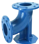
AVK serie 712 FFQN Flensvoetbocht 90° Nodulair gietijzer Epoxy gecoat DN 50-600 Drukklasse PN 16
