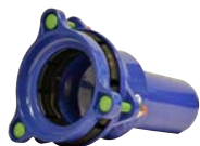
AVK serie 711/80 Orion universele spie koppeling Niet trekvast Nodulair gietijzer EPDM rubber DN 50-200 Drukklasse PN 16
