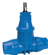
AVK serie 16/50 Dienstleidingafsluiter met trekvaste insteekverbinding voor PE buizen POM (Polyoxymethyleen) DN 25-50 Drukklasse PN 16
