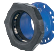
Serie 633/00 Supa Maxi™ universele trekvaste flensadapter Nodulair gietijzer EPDM rubber DN 40-700 Drukklasse PN 16
