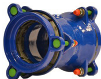
AVK serie 711/50 Orion universele rechte koppeling Niet trekvast Nodulair gietijzer EPDM rubber DN 50-300 Drukklasse PN 16
