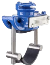
AVK serie 100/85 Supa Lock™ Aanboorzadel voorzien van afsluitcassette voor gietijzeren / stalen buizen Ø 50-360 mm Nodulair gietijzer/roestvast staal Drukklasse PN 16
