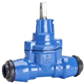
AVK serie 03/00 Dienstleidingafsluiter voorzien van inwendig schroefdraad Nodulair gietijzer DN 25-50 Drukklasse PN 16
