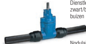
AVK serie 16/90 Dienstleidingafsluiter met PRK koppelingen voor PE buizen POM (Polyoxymethyleen) DN 25-50 Drukklasse PN 16
