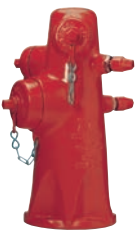
AVK serie 24/90 Bovengrondse brandkraan "Wet Barrel" 2 x 2½" aansluiting + 1 x 4" 7/4½" motorspuitaansluiting Nodulair gietijzer 200 PSI UL listed, FM approved
