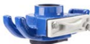
AVK serie 730/5 Aanboorzadel met shut-off blade voor onder druk aanboren op stalen, gietijzeren en andere metalen buizen Nodulair gietijzer DN 50-300
