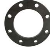
AVK serie 1258/05 Overschuifflens Polypropyleen met stalen kern Flensboring volgens EN1092-1 Diameter 200-600 mm Drukklasse PN 10
