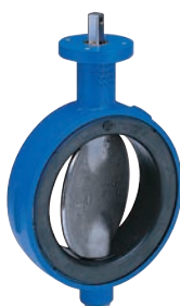
AVK serie 75/10 Centrische vlinderklep met ge vulkaniseerde voering Tussenbouw (Wafer), type EVS Inbouw lengte DIN 3202-K1 Nodulair gietijzer DN 40-1400 Drukklasse PN 10/16
