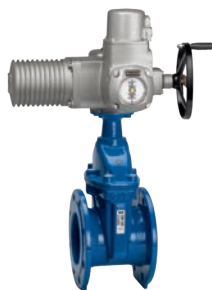
AVK serie 15/43 Flensafsluiter met ISO topflens voor elektrische aandrijving Korte inbouw lengte, F4 RVS 316 spindel NBR schuif Nodulair gietijzer DN 40-400 Drukklasse PN 10/16
