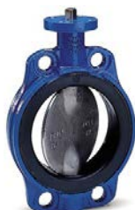
AVK serie 75/31 Centrische vlinderklep met ge vulkaniseerde voering Tussenbouw (Wafer semi-lugged), type EVBLS Inbouw lengte DIN 3202-K1 Nodulair gietijzer DN 50-300 Drukklasse PN 10/16
