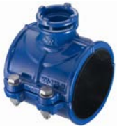
AVK serie 100/00 Supa Lock™ Aanboorzadel voor PE/PVC buizen Ø 63-225 mm Nodulair gietijzer Drukklasse PN 16
