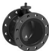
AVK serie 75/21 Centrische vlinderklep met ge vulkaniseerde voering Dubbel geflensd (lang), type EVFL) Inbouwlengte DIN 3202-F4 Nodulair gietijzer DN 50-2000 Drukklassse PN 10/16
