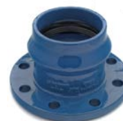
AVK serie 712 E Flensmof stuk Nodulair gietijzer Epoxy gecoat DN 50-600 Drukklasse PN 16
