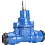
AVK serie 03/30 Dienstleidingafsluiter met trekvaste insteekverbindingen voor PE buizen Nodulair gietijzer DN 25-50 Drukklasse PN 16
