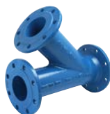
AVK serie 712 FFC Flens T-stuk 45° Nodulair gietijzer Epoxy gecoat DN 80-600 Drukklasse PN 16
