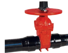
AVK serie 36/00 Afsluiter met PE100/SDR11 uiteinden Post indicator plaat Nodulair gietijzer DN 50-300 Drukklasse PN 16
