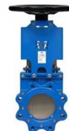
AVK serie 702/10 Plaatafsluiter met niet-stijgende spindel en handwiel RVS plaat Nodulair gietijzer DN 50-1200 Drukklasse PN 10
