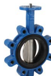
AVK serie 820/10 Centrische vlinderklep met losse voering Lug type Inbouw lengte volgens DIN/EN558-1, serie 20 (K1) Nodulair gietijzer DN 25-600 Drukklasse PN 10/16
