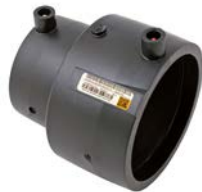
AVK serie 1202/01 Verloopp koppeling PE100 zwart Automatische pin van 4 mm Polyethyleen (PE) Diameter 20x25-180x125 mm Drukklasse PN 16
