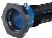
Serie 635/00 Supa Maxi™ universele trekvaste overgangs- koppeling met gemonteerde PE100 buis Nodulair gietijzer EPDM rubber DN 50-300 Drukklasse PN 10 (SDR17) of PN 16 (SDR11)
