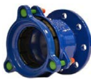
AVK serie 711/60 Orion universele flensadapter Niet trekvast Nodulair gietijzer EPDM rubber DN 50-300 Drukklasse PN 16
