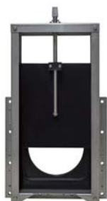
AVK serie 970/1601 Rioolspindelschuif Gesloten frame tbv. wandmontage Frame RVS 316 Schuif HDPE EPDM afdichting DN 200-1000
