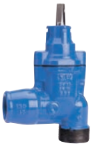
AVK serie 11/30 Haakse dienstleidingafsluiter met uitwendig draad op inlaat en trekvaste insteekverbinding voor PE buizen op uitlaat Nodulair gietijzer DN 25-50 Drukklasse PN 16
