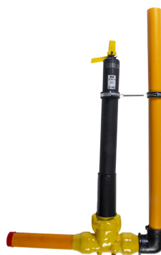
AVK serie 971 Gasafblaasunit voor onder druk aanboren op PE leiding Vervangbare spindelafdichting Uitwendig voorzien van gele PUR coating DN 50 Drukklasse PN 16
