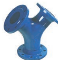
AVK serie 712 ETV Trekvast E-stuk, type Dyka Nodulair gietijzer Epoxy gecoat DN 100-500 Drukklasse PN 16
