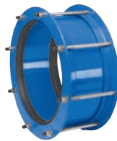
AVK serie 258 Op maat gemaakte rechte koppeling voor AC, stalen, grijs of nodulair gietijzeren leidingen Staal DN 350-2000 Drukklasse PN 8 t/m PN 25
