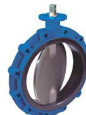
AVK serie 75/41 Centrische vlinderklep met ge vulkaniseerde voering Monoflens, type EVTLS Inbouw lengte DIN 3202-F16 Nodulair gietijzer DN 50-1000 Drukklasse PN 10/16
