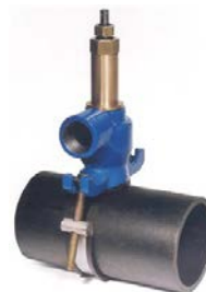
AVK serie 727/08 Aanboorzadel SWIC-ST voor onder druk aanboren Met geïntegreerde frees voor gietijzeren, AC en stalen buizen Nodulair gietijzer DN 80-300 Drukklasse PN 16
