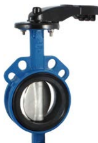
AVK serie 820/00 Centrische vlinderklep met losse voering Wafer type Inbouw lengte volgens DIN/EN558-1, serie 20 (K1) Nodulair gietijzer DN 25-1000 Drukklasse PN 10/16
