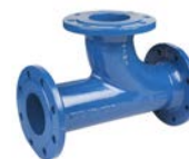
AVK serie 712 SCH Flens stroom-T-stuk, Nodulair gietijzer Epoxy gecoat DN 80-600 Drukklasse PN 16
