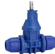
AVK serie 16/59 Dienstleidingafsluiter met trekvaste Pentomech™ koppelingen voor PE buizen POM (Polyoxymethyleen) DN 25-50 Drukklasse PN 16
