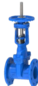
AVK serie 21/34 Flensafsluiter met stijgende RVS 316 spindel en handwiel Inbouw lengte volgens EN 558-2 serie 3 Nodulair gietijzer DN 50-400 Drukklasse PN 10/16
