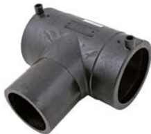
AVK serie 1204/01 T-stuk PE100 zwart Automatische pin van 4 mm Polyethyleen (PE) Diameter 20-250 mm Drukklasse PN 16
