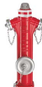
AVK serie 84/16 Bovengrondse brandkraan, type P7 met kogel, breekboutbeveiliging, 2x storzkoppeling en 1x motorspuitaansluiting Dubbele afdichting Nodulair gietijzer DN 100 1000-1500 mm Drukklasse PN 16
