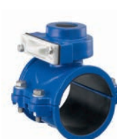
AVK serie 727/10 Aanboorzadel met shut-off blade Voor PE/PVC buizen DN 80-200 Drukklasse PN 16
