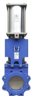
AVK serie 702/40 Plaatafsluiter met dubbelwerkende pneumatische aandrijving RVS plaat Nodulair gietijzer DN 50-1200 Drukklasse PN 10
