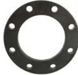
AVK serie 1258/05 Overschuifflens Polypropyleen met stalen kern Flensboring volgens EN1092-1 Diameter 200-600 mm Drukklasse PN 10
