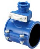
AVK serie 100/30 Supa Lock™ Aanboorzadel voorzien van afsluitcassette voor PE/PVC buizen Nodulair gietijzer DN 80-200
