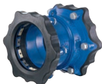
Serie 632/00 Supa Maxi™ universele trekvaste verloop koppeling Nodulair gietijzer EPDM rubber DN 50-300 Drukklasse PN 16
