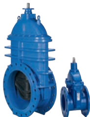
AVK serie 06/84 Flensafsluiter Korte inbouw lengte, F4 RVS 316 spindel NBR schuif Nodulair gietijzer DN 40-1200 Drukklasse PN 10/16
