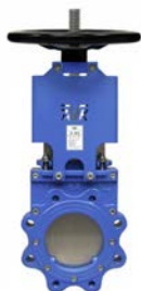
AVK serie 702/20 Plaatafsluiter met stijgende spindel en handwiel RVS plaat Nodulair gietijzer DN 50-1200 Drukklasse PN 10
