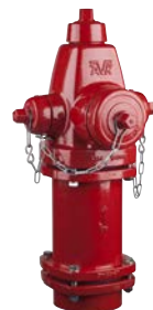
AVK serie 27/00 Bovengrondse brandkraan "Dry Barrel" Modern type 2 x 2" aansluiting + 1 x 4" motorspuitaansluiting Gronddekking: 305-2438 mm Nodulair gietijzer 250 PSI UL/ULC listed FM approved
