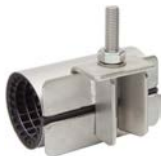
AVK serie 748/41 Reparatieklem, type C EPDM of NBR rubber RVS 304L of 316L DN 15-100
