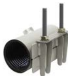
AVK serie 748/21 Reparatieklem, type FSA10 met ge vulkaniseerde spannerplate Draadaftakking ½"-2" EPDM of NBR rubber RVS 304L of 316L DN 40-350
